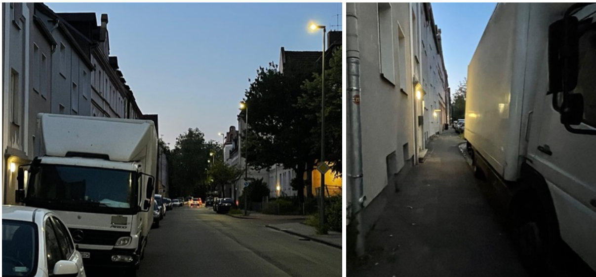
Abbildung 47: Einseitige Straßenbeleuchtung durch großformatige Lampen in der Wiesenstraße im Quartier Marxloh Grillo/Schwelgern und Schattenbildung hinter einem Lkw auf der anderen Straßenseite
