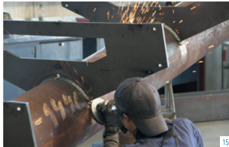
Abb. 13-15) Vormontage bei der Firma Gründken in Nottuln, Probeaufbau der Looping- und Tragrohrsegmente zur Anpassung der Treppen- und Geländergeometrie, Schleifen der Schweißnähte an den Querträgern, Mai-September 2011
