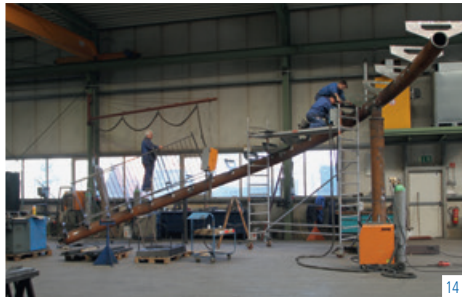
Abb. 13-15) Vormontage bei der Firma Gründken in Nottuln, Probeaufbau der Looping- und Tragrohrsegmente zur Anpassung der Treppen- und Geländergeometrie, Schleifen der Schweißnähte an den Querträgern, Mai-September 2011
