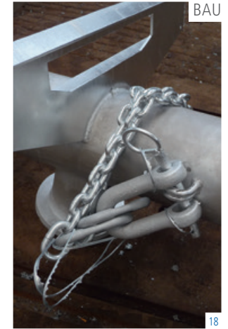
Abb. 16-18) Feuerverzinkung bei der Firma Voigt & Schweitzer in Gelsenkirchen, Auftauchen und Abkühlung der Tragrohre, Detail Hängevorrichtung zur Verzinkung, Juni-September 2011
