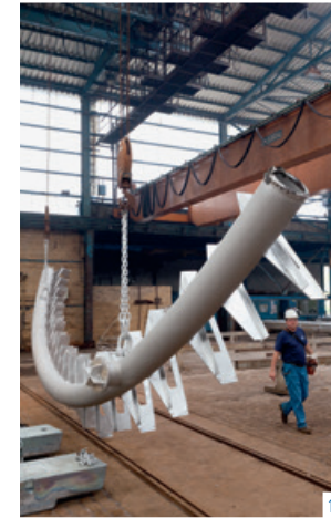
Abb. 16-18) Feuerverzinkung bei der Firma Voigt & Schweitzer in Gelsenkirchen, Auftauchen und Abkühlung der Tragrohre, Detail Hängevorrichtung zur Verzinkung, Juni-September 2011
