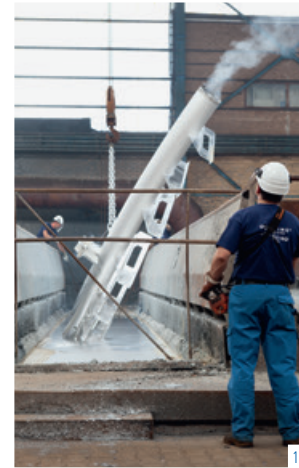
Abb. 16-18) Feuerverzinkung bei der Firma Voigt & Schweitzer in Gelsenkirchen, Auftauchen und Abkühlung der Tragrohre, Detail Hängevorrichtung zur Verzinkung, Juni-September 2011
