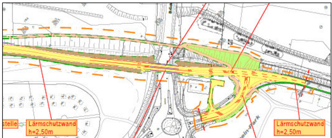
Abbildung 30: Vorzugsvariante – Verkehrsführung südlicher Anschluss
