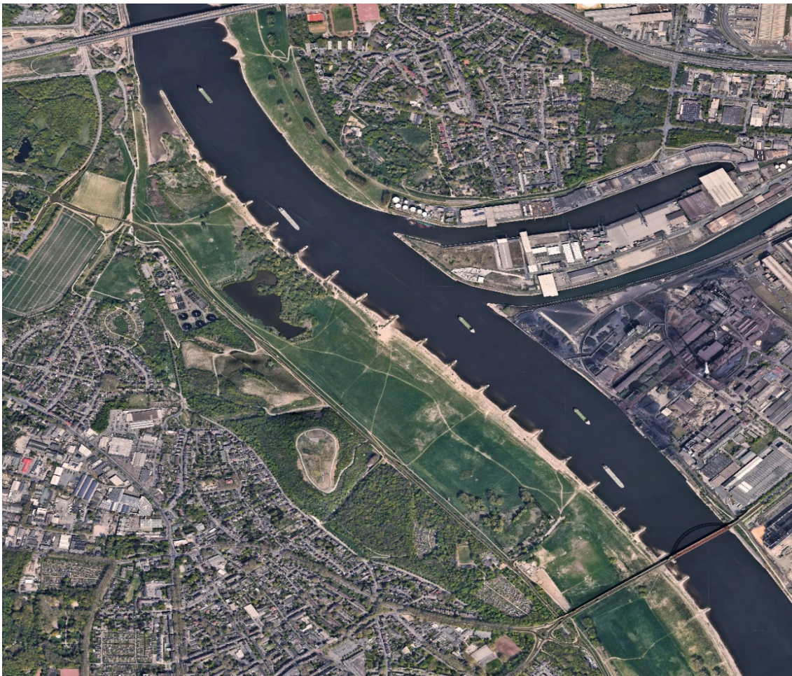
Abbildung 1: Luftaufnahme geplante Trassierung auf Deichkrone
